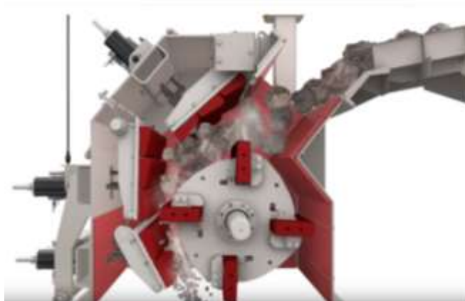
8.3. attēls. Rotorveida drupinātāja (frakcijai virs 70 mm) darbības principa attēlojums (ilustratīvs materiāls).
