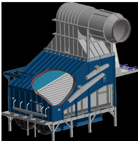
5.1. attēls. Kustīgo ārdūņu sadegšanas kameras piemērs 9
