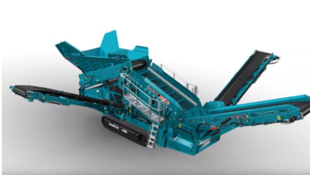
8.1. attēls. Sijāšanas iekārta izraktā materiāla sākotnējai frakcionēšanai ( ilustratīvs materiāls ).
